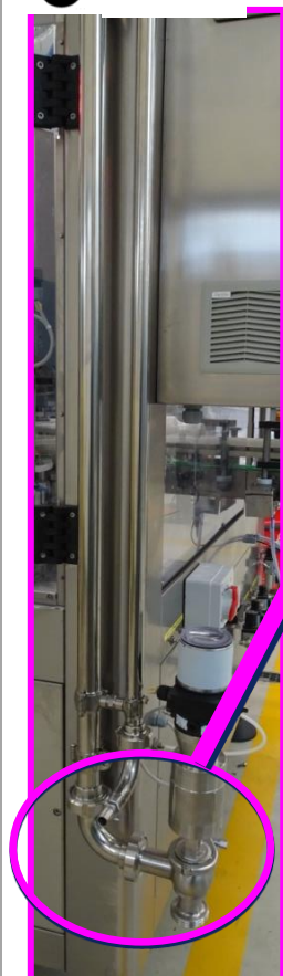
Рис. 3-24: соединение для слива CIP
