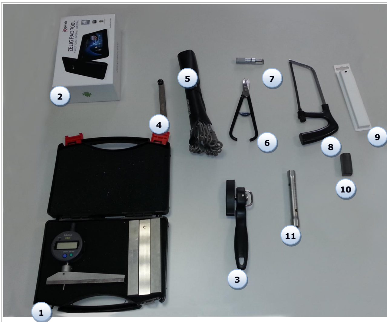
Рис. 5-9 Комплект принадлежностей для регулирования закаточных швов (ОПЦИОН)
