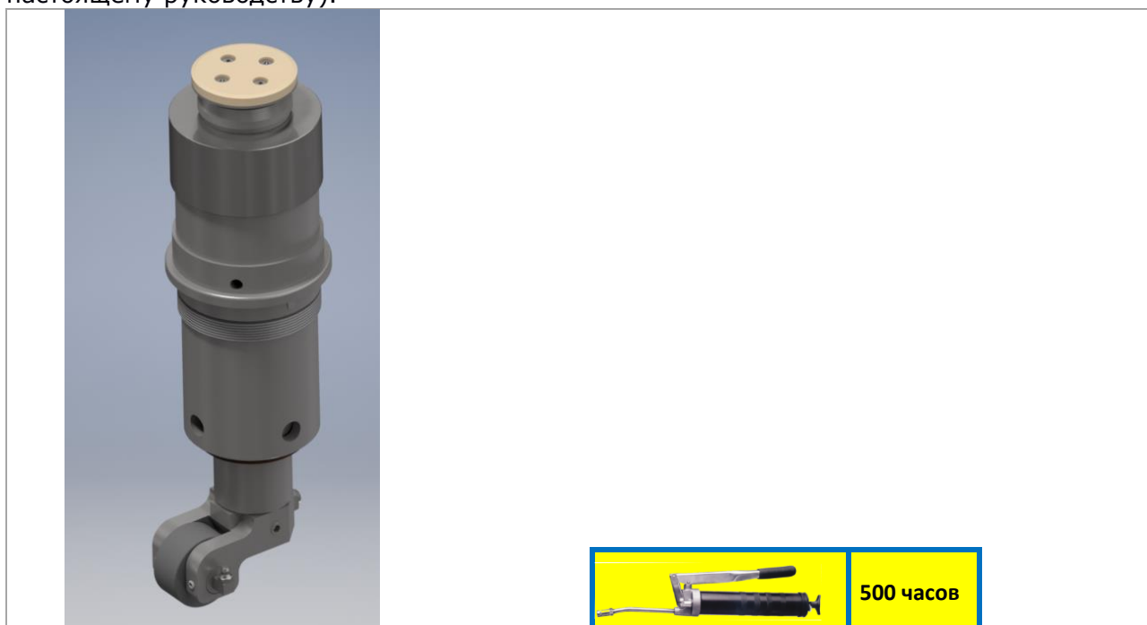
Рис. 7-57 Смазка цилиндра подъёма банки
